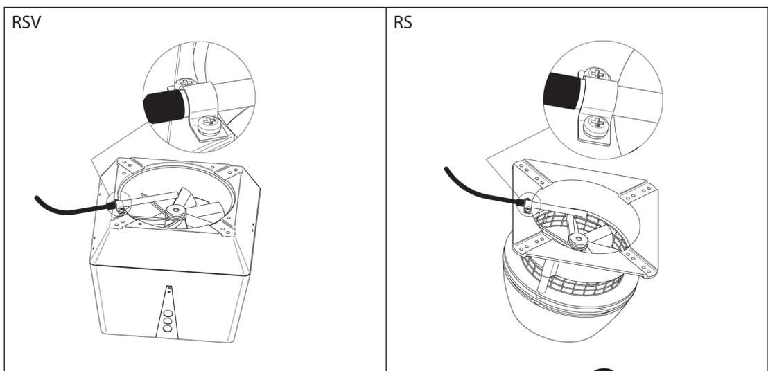
Om en motfläns FRx-AFD används: Ta bort pluggen från röret, och montera in tempgivaren i röret: Dra åt skruven (A).
