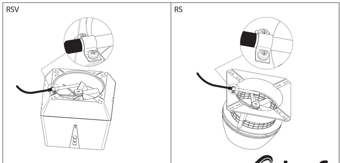
En utilisant une bride FRx-AFD: Enlevez le bouchon et entrez le détecteur de température. Serrez le vis de fixation (A).
