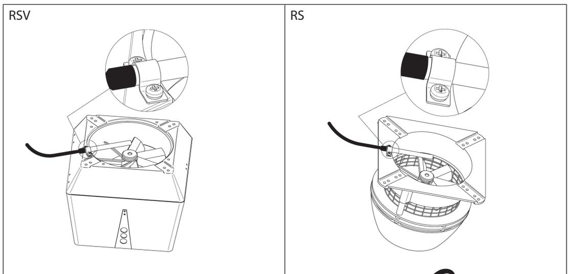
Wenn Sie ein FRx-AFD Abdeckung verwenden, bitte den Stopfen von der Tauchhülse entfernen und Temperaturfühler einführen. Mit der Schraube fixieren (A).
