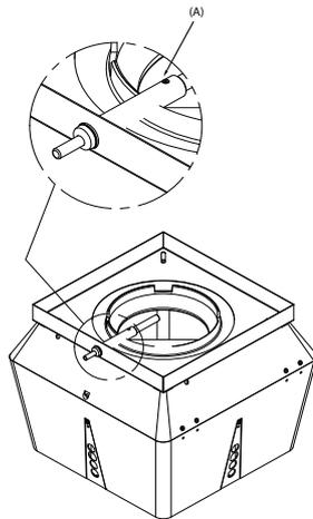
En utilisant une bride FRx-AFD: Enlevez le bouchon et entrez le détecteur de température. Serrez le vis de fixation (A).
