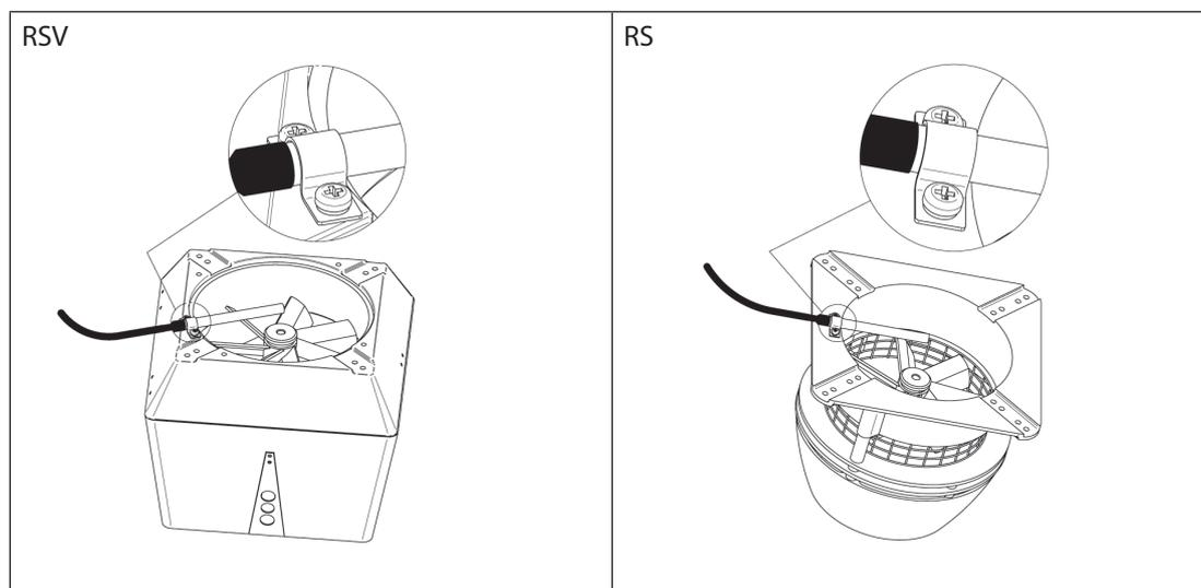
Hvis der bruges en FRx-AFD flange: Fjern proppen fra røret, og indsæt sensoren. Stram skruen (A).
