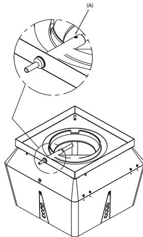
Hvis der bruges en FRx-AFD flange: Fjern proppen fra røret, og indsæt sensoren. Stram skruen (A).
